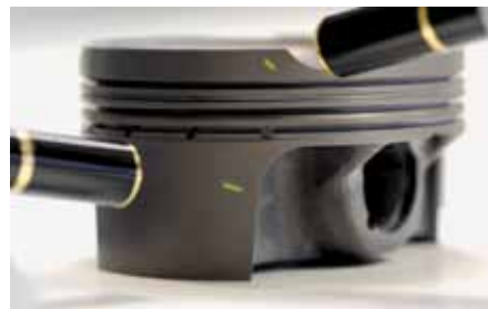
Abb. 1: Die Markerschicht auf einem Motorkolben dient der Authentifikation und zeigt in Doppelfunktion auch einen Verschleiß an
