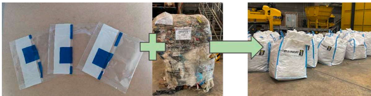
Abbildung 5 Markierte Verpackungsbeutel (links, 25 µg/cm 2 Tracer in weißer Tinte) werden mit Hausmüll (Mitte) gemischt
